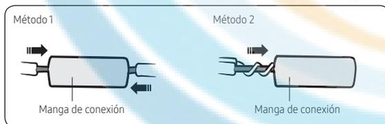
4 Con la ayuda de una herramienta pelacables, comprima los dos puntos y voltéelos para comprimir otros dos puntos en la misma ubicación.
